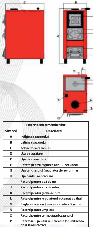
Figura nr. 2 Desenul tehnic al cazanului Celsius P-35 pe combustibil solid
